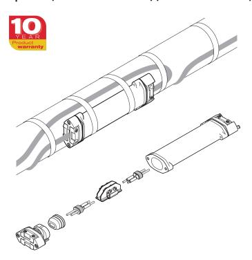
Набор nVent RAYCHEM S-150 — компактная муфта для сращивания греющих кабелей. Этот универсальный набор предназначен для использования со всеми типами греющих кабелей nVent RAYCHEM BTV, QTVR, XTV, KTV. Может применяться при температурах от  $-55^{\circ}$ C до  $+200^{\circ}$ C; сертифицирован для применения во взрывоопасных зонах.
